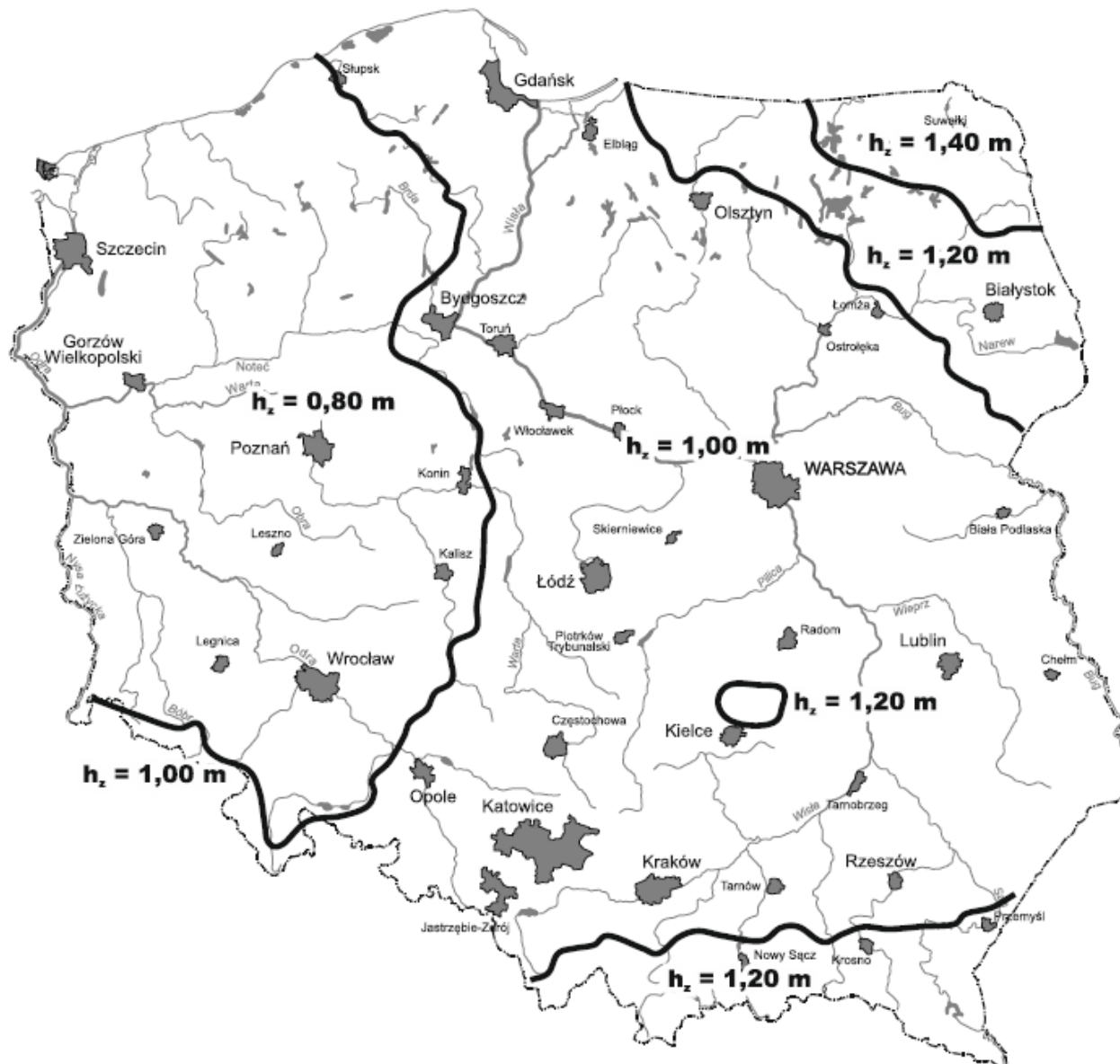
Rys. 3. Głębokość przemarzania gruntu h_z wg PN-81/B-03020
