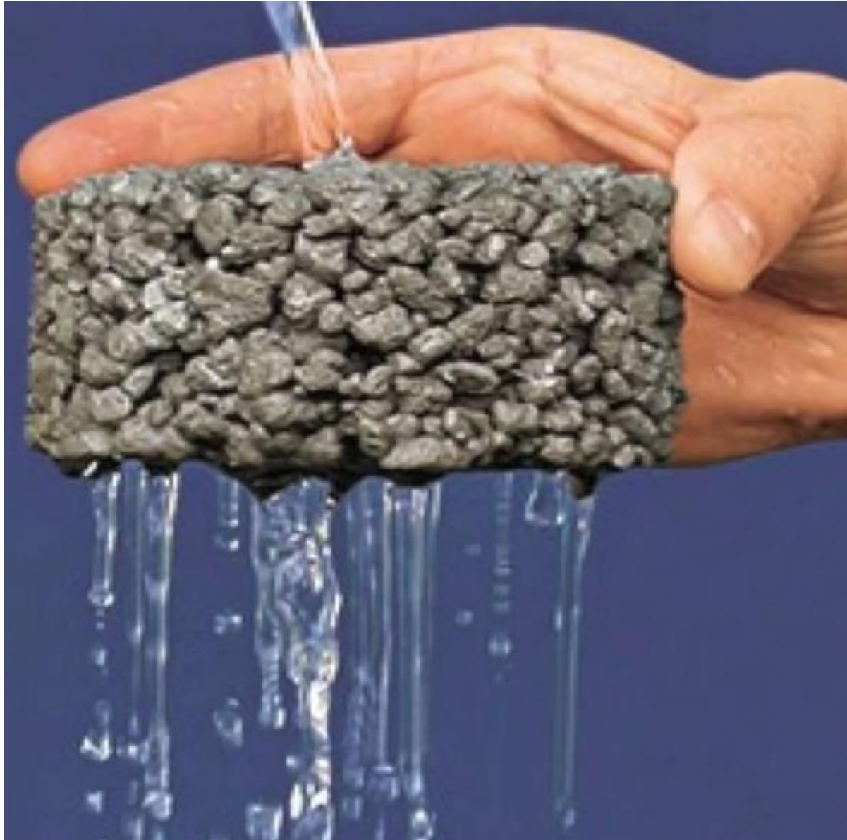
Rys. 13 Przepływ wody przez mieszankę typu PA
