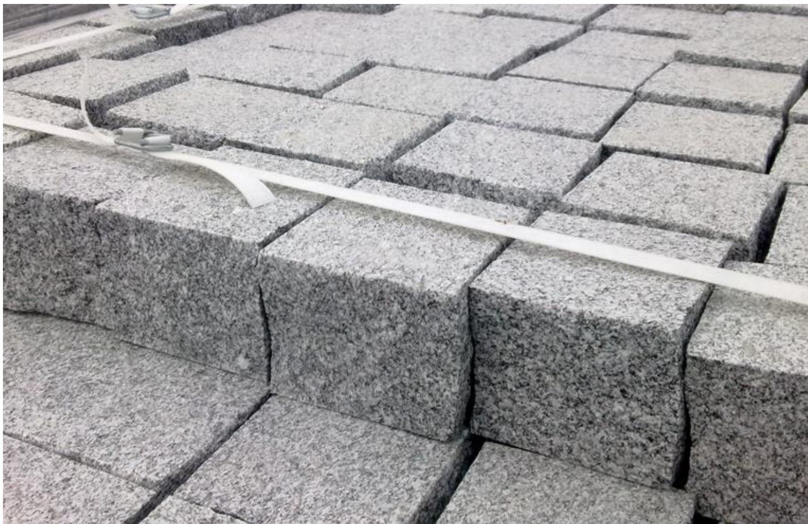
Rys. 49. Kostka regularna normalna
