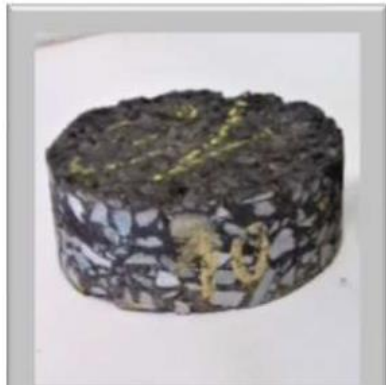
Rdzeń z nawierzchni
