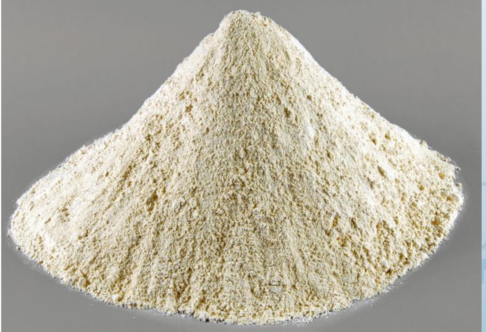
Rys. 2. Przykładowy wypełniacz do zastosowania w mieszance mineralno-asfaltowej (wypełniacz wapienny)
