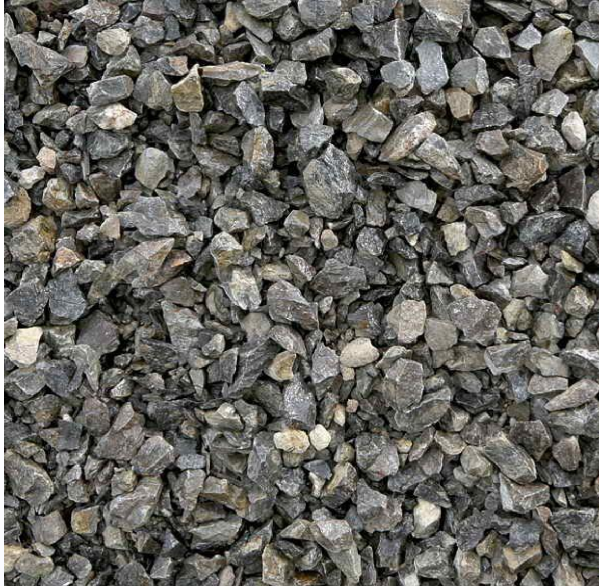
Rys. 1. Przykładowe kruszywo do zastosowania w mieszance mineralno-asfaltowej (kruszywo łamane – kliniec)
