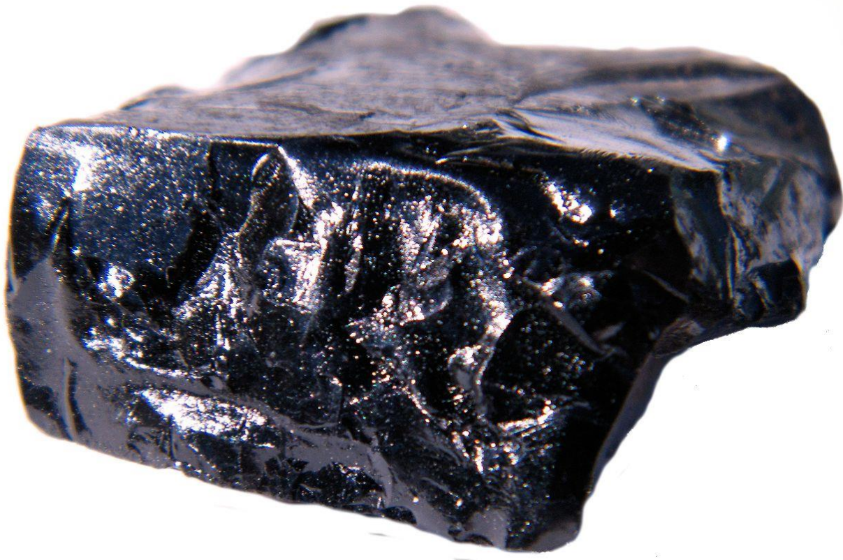
Rys. 4. Minerał (asfaltyt) uintahite (Gilsonite) wydobyty w kopalni Fort Duchesne (Utah, USA)
