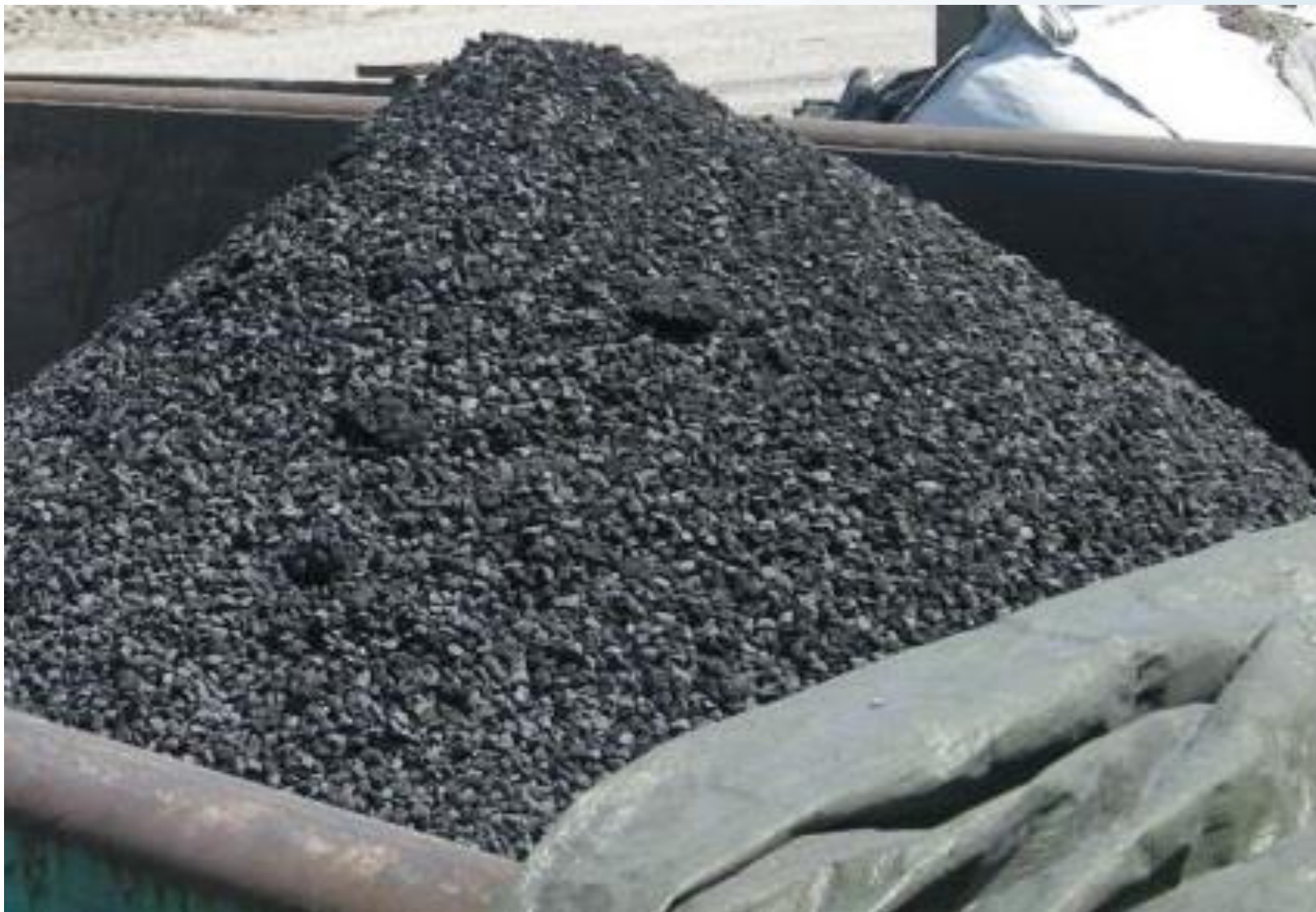
Rys. 6. Fotografia przekruszonego piasku roponośnego Selenizza (Albania)
