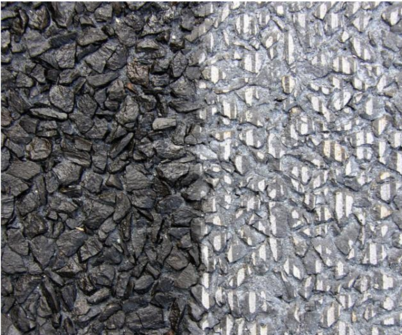
Rys. 7. Tekstura warstwy ścieralnej z SMA
