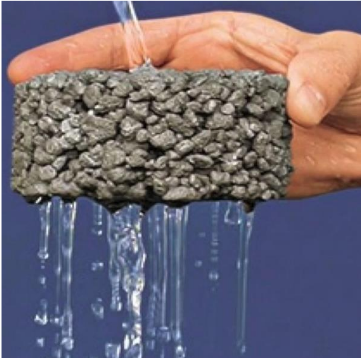
Rys. 13 Przepływ wody przez mieszankę typu PA
