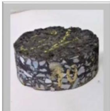
Rdzeń z nawierzchni
