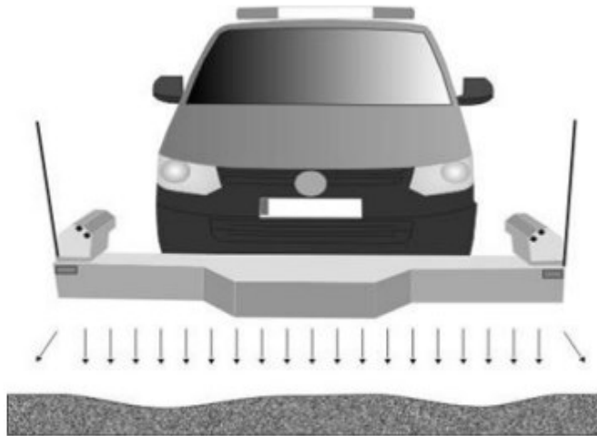
Schemat poglądowy pomiaru równości poprzecznej za pomocą profilografu
