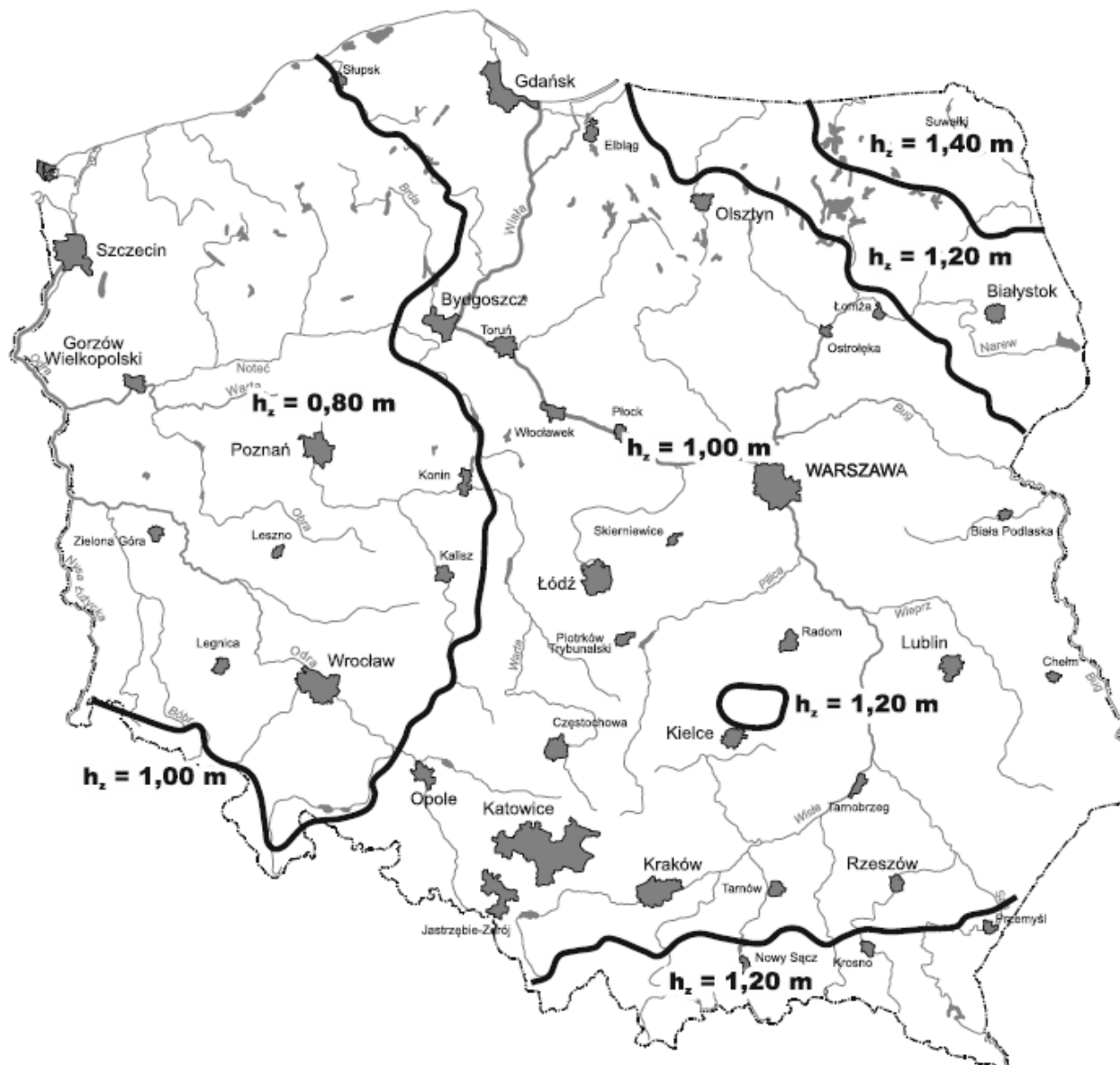
Rys. 3. Głębokość przemarzania gruntu h_z wg PN-81/B-03020
