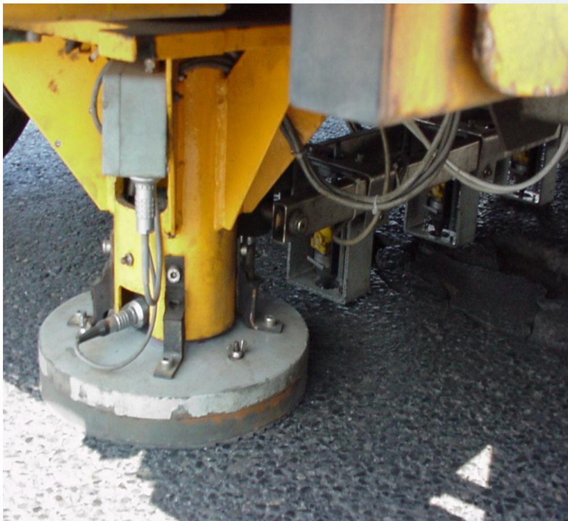
Rys.5. Pomiar ugięć przy użyciu ugięciomierza dynamicznego FWD
